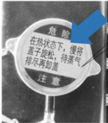
Figure 27 Schéma du bouchon de pression sur le radiateur
